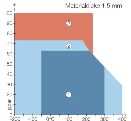
Durch die Streckmetall-Armierung wird die schon hohe Druckstandfestigkeit noch weiter verbessert und eine hohe Festigkeit gegen mechanische Belastungen im Flanschbereich (Dehnung durch Temperaturwechsel) erreicht. Um Druckschwankungen abzufangen, können nun auch höhere Schraubenkräfte aufgebracht werden, ohne die Dichtung zu zerstören. Außerdem bietet die Streckmetall-Armierung einen Ausblasschutz im Schadenfall.
